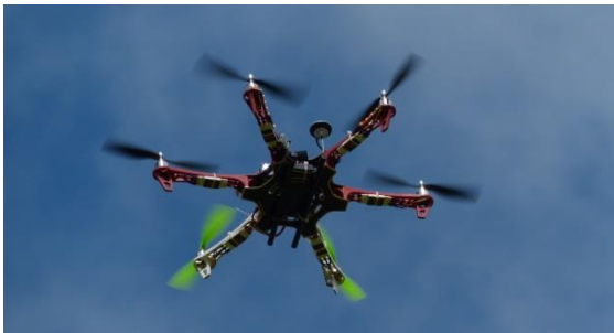
Testflug der Drohne der Universität Wageningen mit GPS und Hyperspektralkamera
