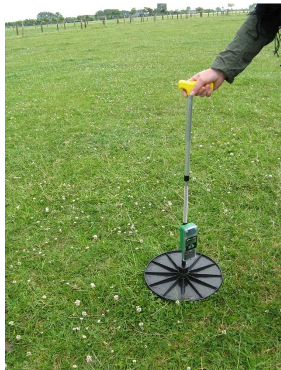
Messung der Aufwüchshöhen mit digitalem Herbometer
