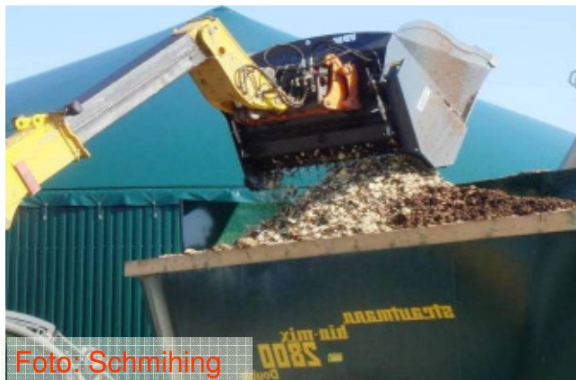
Rübenzerkleinerung beim Laden:
