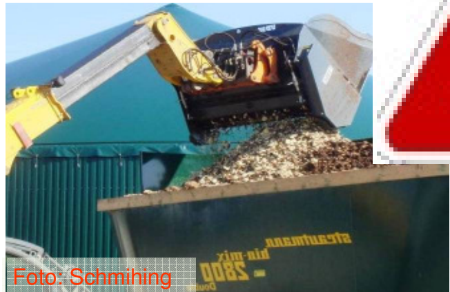
Rübenzerkleinerung bei Laden:
