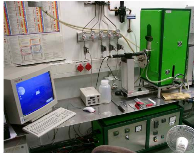
Ofen mit Kamera und Vergrößerung
