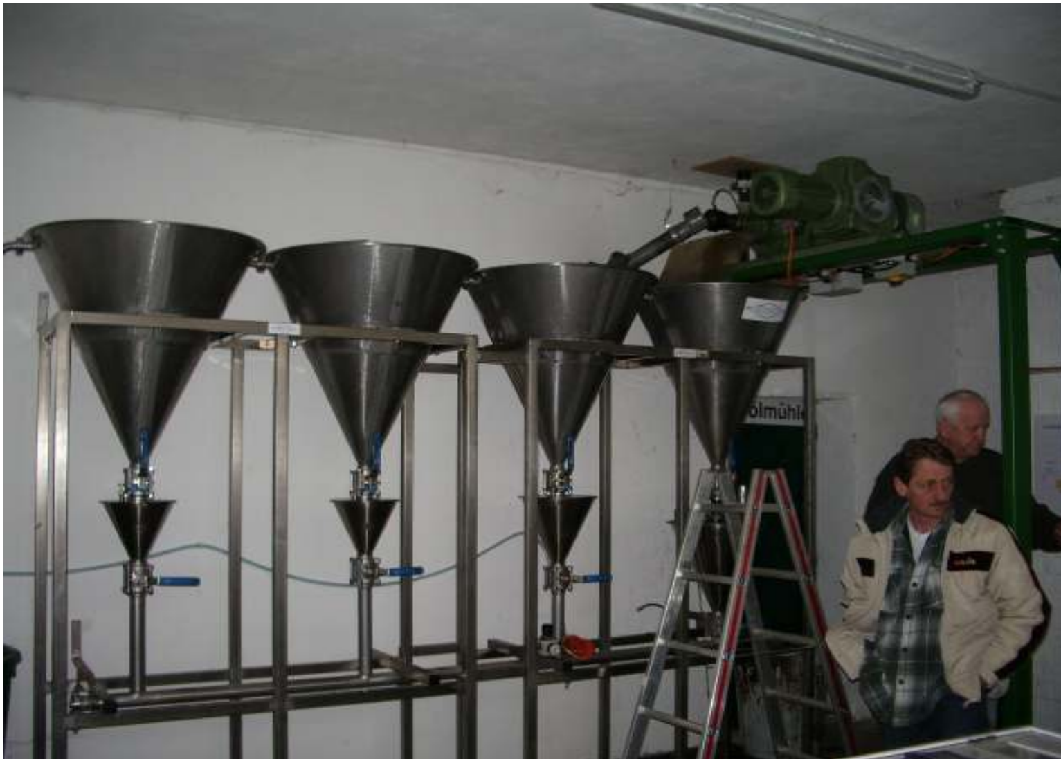
Sedimentationsanlage (vierstufig) , System Weihenstephan
